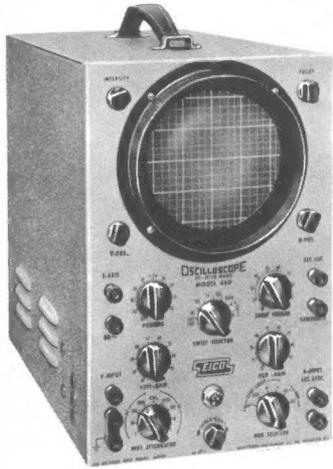
**EICO** Breitband-Oszillograph Modell 460
