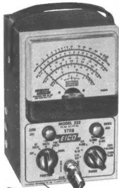
**EICO** Röhrenvoltmeter Modell 232
